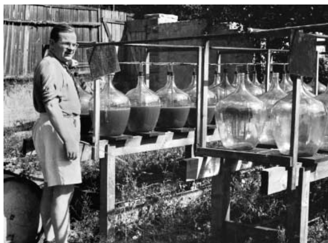
Schencks Solarbestrahlungs-Pilotanlage zur Ascaridol-Produktion durch Methylenblau-sensibilisierte Photooxidation von \alpha -Terpinen in Isopropanol in seinem Garten in Heidelberg-Ziegelhausen (1949).
